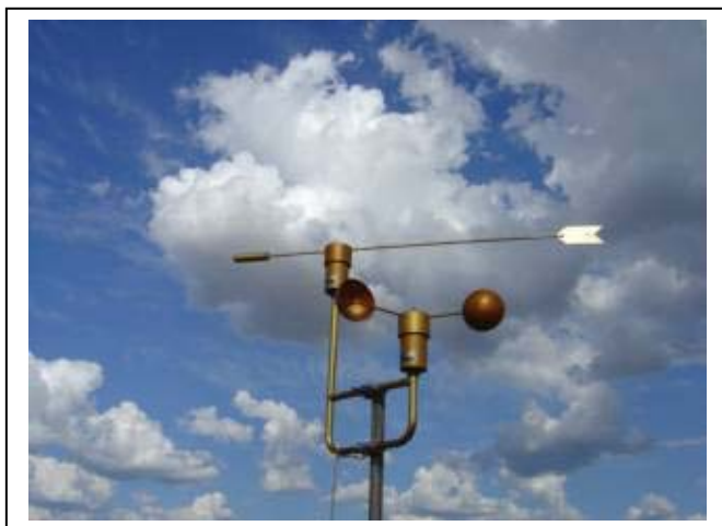
Figura 37 - Anemômetro e biruta
