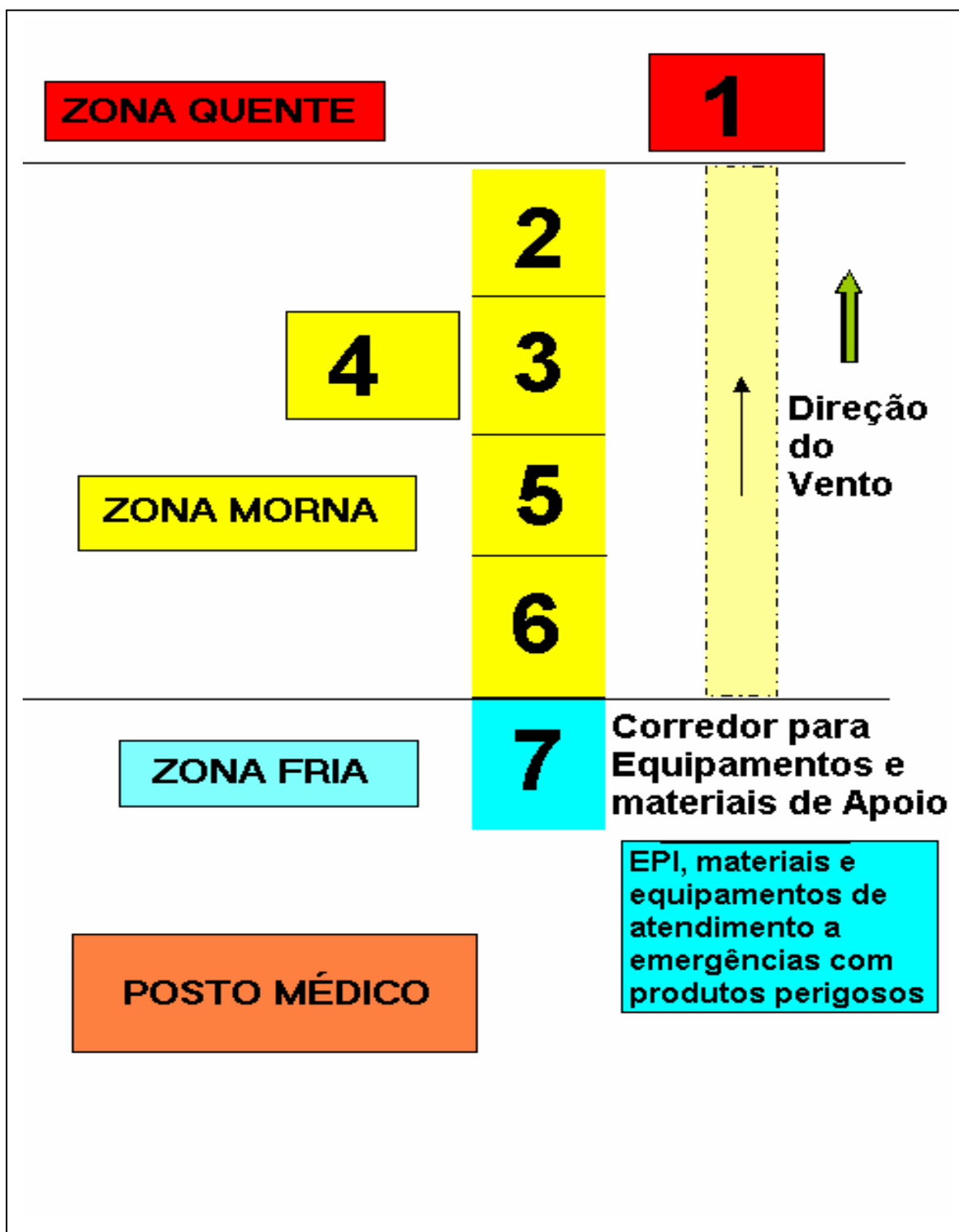
Figura 21 - Esquema de montagem do Corredor de Descontaminação
