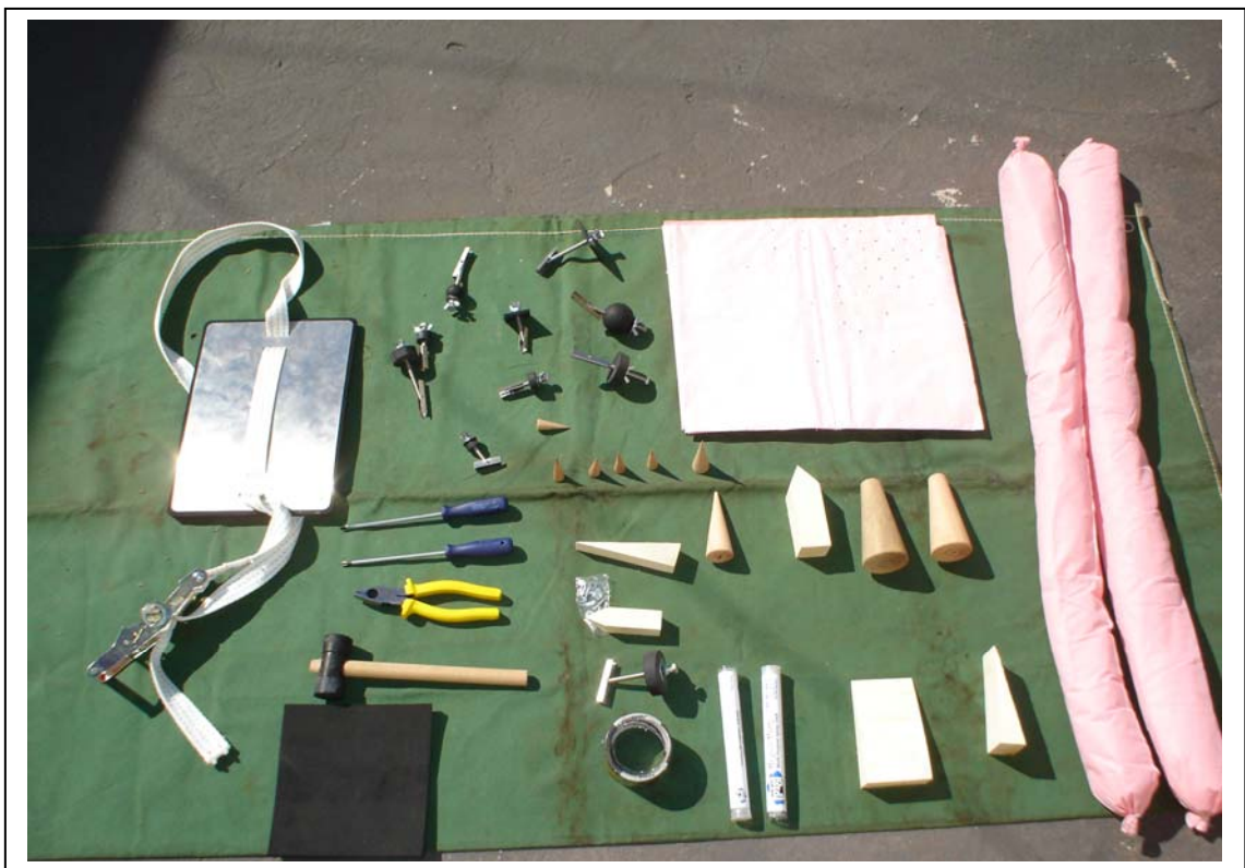
Figura 39 - Materiais de contenção e estancamento
